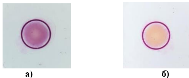
Рис. 1. Прототип фоточувствительного маркера в работе – а) до испытания на солнце б) после испытания на солнце
