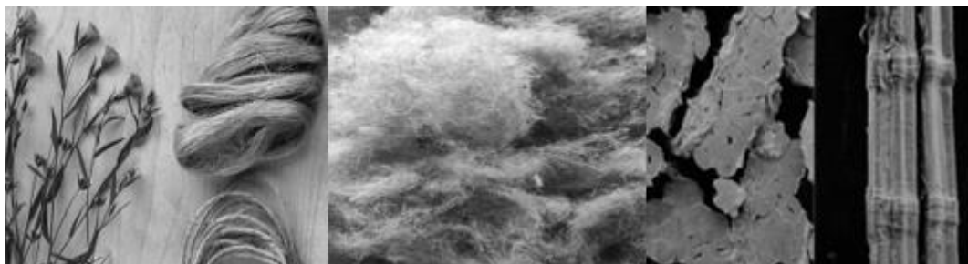
Рис.1. Микрофотографии котонизированного льняного волокна
