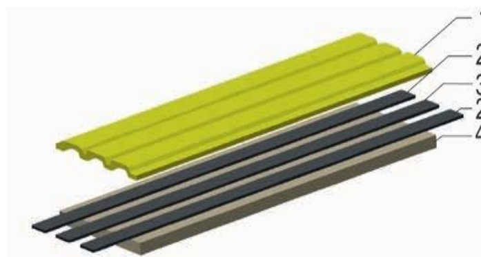
Рис. 2. ТСЛ второго типа: 1 – верхняя подложка, 2 – сигнальный тракт, 3 – сигнальный путь, 4 – подложка из ткани
